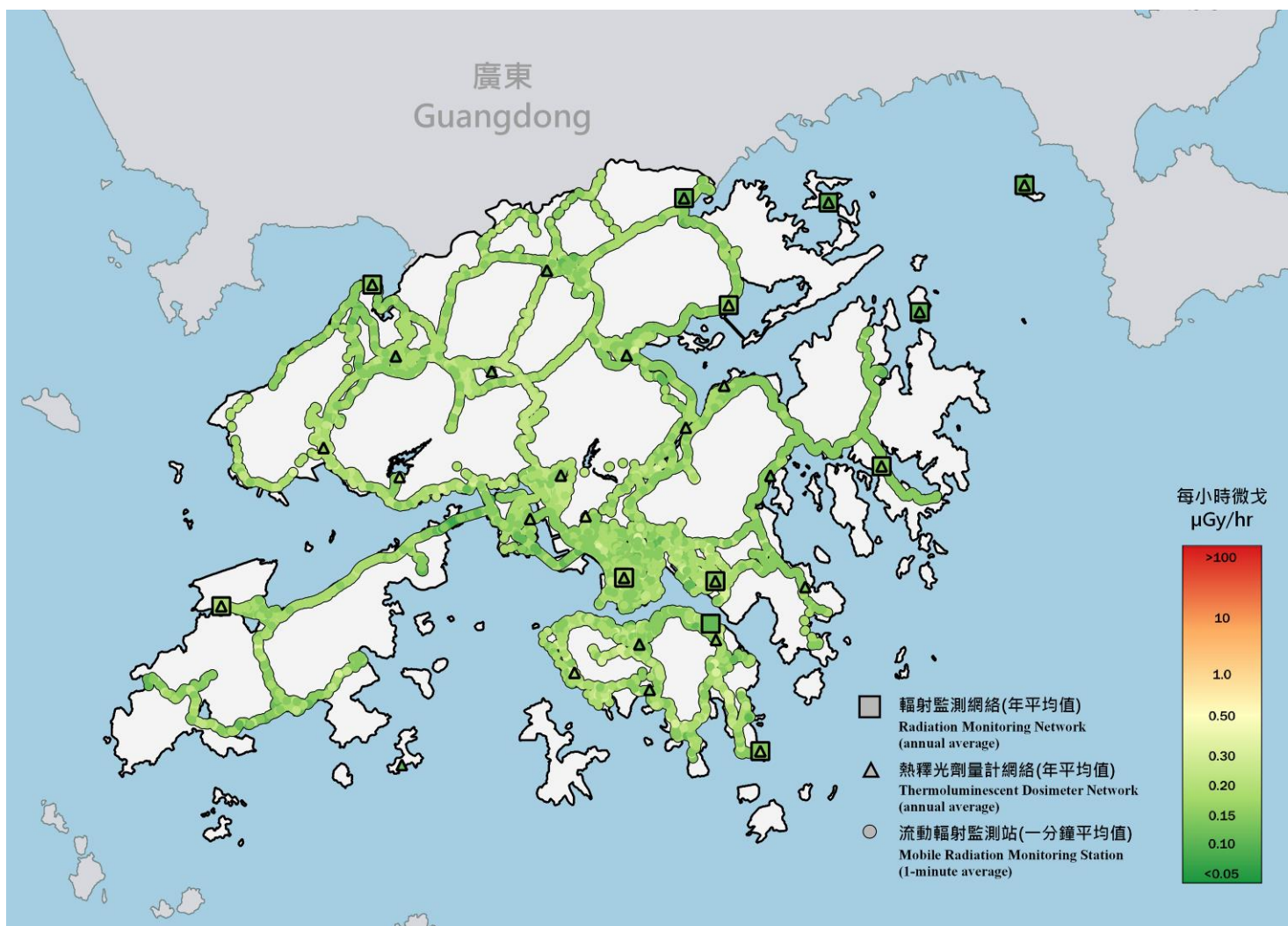
圖 6. 二零一八年：(a) 流動輻射監測站於巡測路線上錄得的一分鐘平均環境伽馬劑量率；(b)(i)輻射監測網絡及(ii)熱釋光劑量計網絡錄得的全年平均環境伽馬劑量率。
