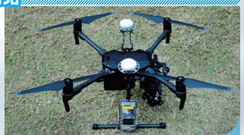
安裝在無人機上的微氣候監測儀器
