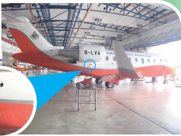
天文台與政府飛行服務隊合作，利用定翼機進行的「追風」任務，今年進入新里程。新的定翼機加裝了下投式探空儀，飛機在高空投下探空儀，儀器在下降時量度天氣數據，相對於以往的定點觀測，大大增加探測數據能力，對熱帶氣旋的監測和預報均有幫助。
