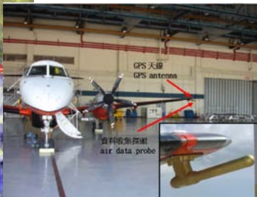
▲ 安裝在定翼機上的氣象儀器，小圖顯示感應器的外貌。
