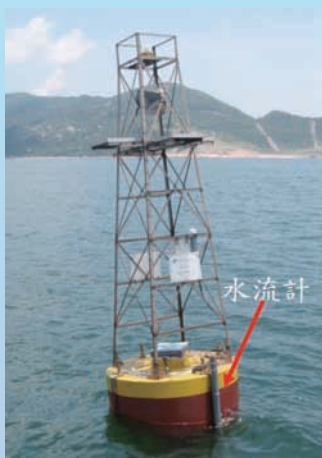
圖 1 天文台在大潭灣所設置的玻璃纖維浮標及水流計
