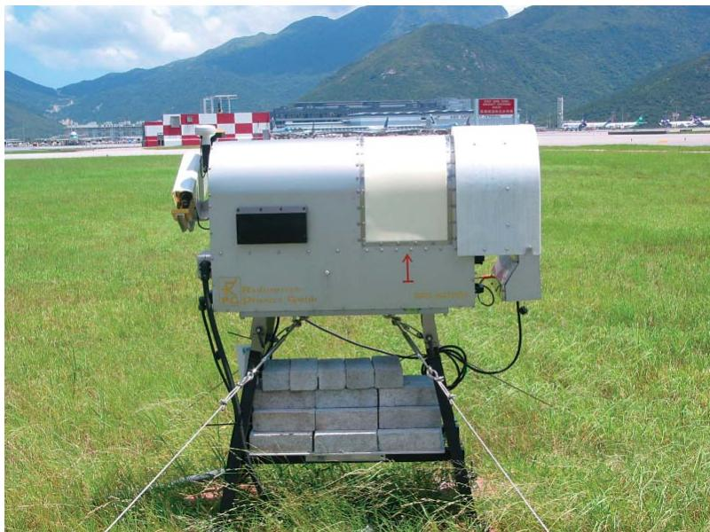
圖一：在機場運行的微波輻射計
