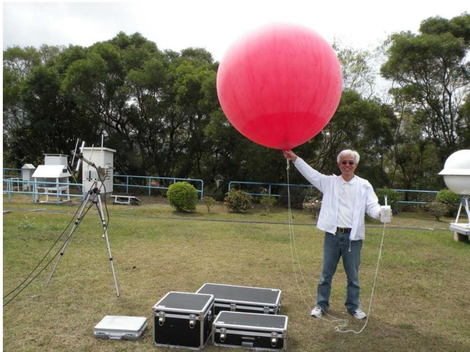
圖十一：便攜式高空探測系統
