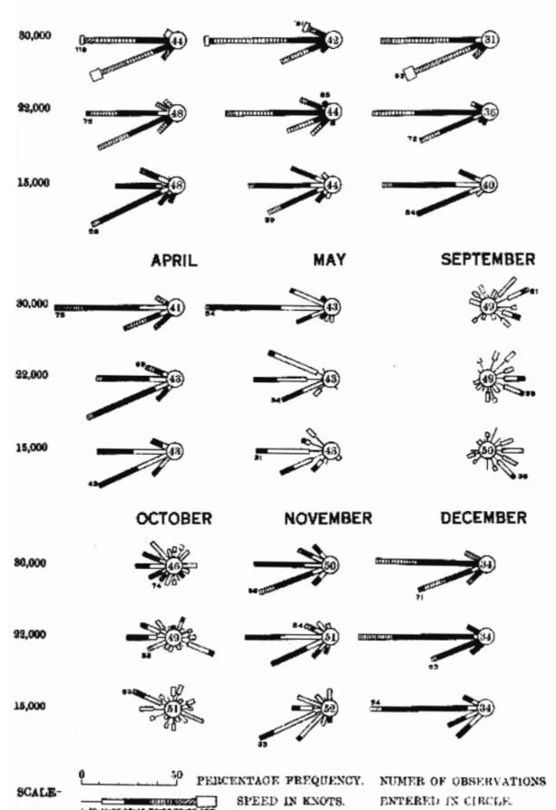
THE GREATEST OBSERVED WIND SPEED IS MARKED IN FIGURES AGAINST THE CORRESPONDING COMPASS POINT ON EACH WIND BOSE.
