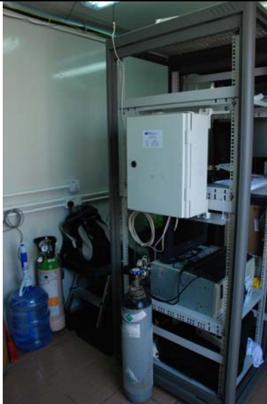
圖 6 安裝在理大本底大氣監測站內的二氧化碳分析儀(上圖左)，入氣口(上圖右)安裝在離地面約 3 米高的金屬架上。
