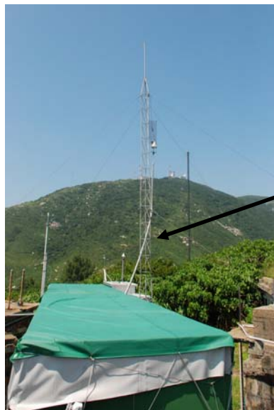
圖 6 安裝在理大本底大氣監測站內的二氧化碳分析儀(上圖左)，入氣口(上圖右)安裝在離地面約 3 米高的金屬架上。
