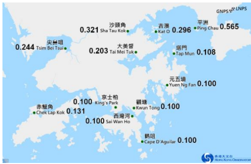
图 6 上图分别为天文台辐射监测站 (左) 及消防局应急辐射监测站(右)12 月 20 日中午时分的模拟实时环境伽马剂量率时间序列及分布。
