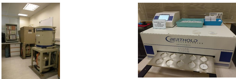
图 3 京士柏辐射实验室的伽马谱法仪及低本底阿尔法-贝他粒子计数系统。
