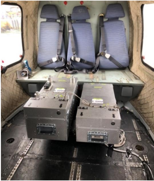
图 4 流动监测站：直升机上的空中辐射监测系统（左图）及辐射巡测车（右图）。
