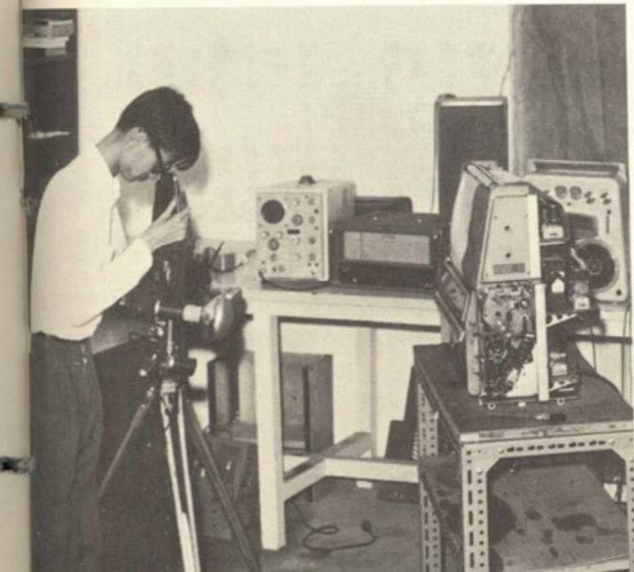
丘文廣正在調整他的攝影機。美國氣象衛星「伊莎二號」和「雨雲二號」過香港時，傳來訊號由香港天文台自製的天綫收到後記錄下來，然後傳送到改裝後的舊電視機中去。丘文廣準備把電視機上映出的雲層圖攝下來。
