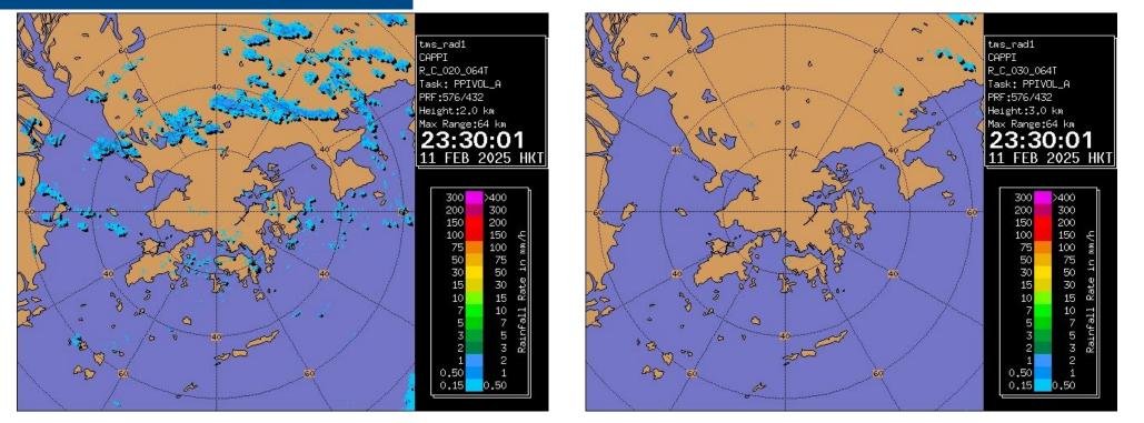
2025年2月11日晚上的天氣雷達圖像,當中離海平面2公里高的圖像(左圖)比3公里的圖像(右圖)顯示更多雷 達回波,更清楚地反映大氣低層的雨區發展情況
