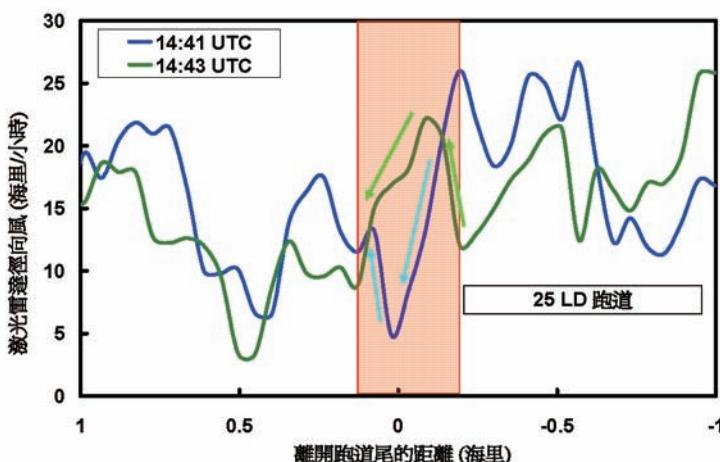
地形引致的風切變中，逆風減弱和增強可以在同一條跑道上出現。下圖是二零零五年二月十四日從激光雷達探測到逆風廓線所顯示的例子。
