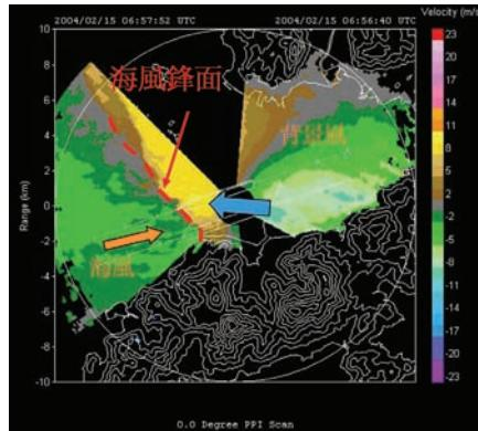
二零零四年二月十五日的激光雷達圖像。冷/暖色代表吹向/離開激光雷達的風(參見右面標度)。虛線代表背景的東風遇上由海風帶來的西風的邊界，也就是海風鋒面的地方。
