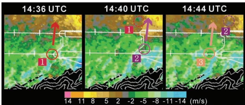
二零零四年八月三十日的激光雷達圖像。冷/暖色代表吹向/離開雷達的風(參見底部標度)。箭咀表明由圓圈標記的風切變在隨後四分鐘內的移動。
