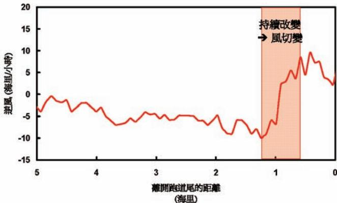
下圖顯示從飛機飛行數據提取的逆風廓線，當時飛機在下降香港國際機場時遇到強西南風下的擾動氣流。紅色區域代表飛機遇到顯著的湍流，當時飛行員報告在下滑道上遇到中度至強烈的湍流。
