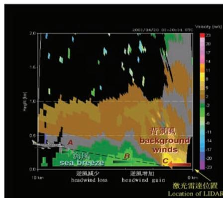
二零零三年四月二十日激光雷達垂直剖面圖。虛線代表下滑道，灰色曲線(接近零速度)分隔底層的海風(冷色)和上層的背景風(暖色)。
