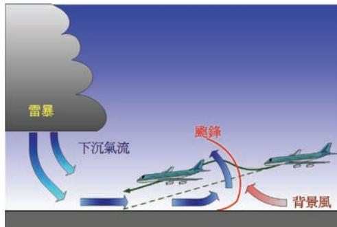
下圖是激光雷達探測到的颱鋒的例子，背景南風和從雷暴下沉氣流帶來的東北風所產生的輻合線就是颱鋒的位置。
