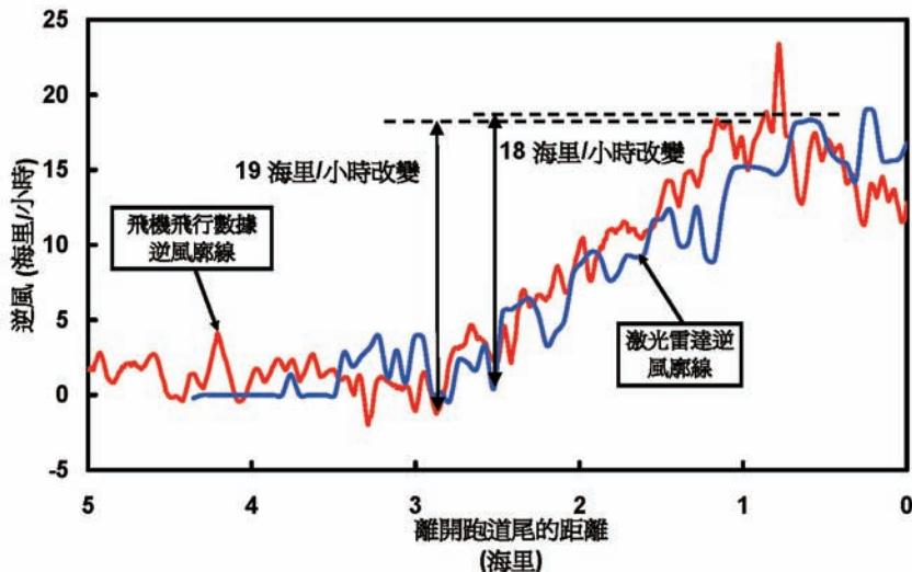
尤其對於離開的飛機來說，“緩變的風切變”可能被視為不重要，這是由於起飛的飛機一般都處於全速加速狀態，飛行員一般會預期風速會隨高度逐漸增加。因此，激光雷達風切變預警系統對下降和起飛的跑道採用不同的水平空間尺度來發出預警，對起飛的飛機，所採用的空間尺度較短。
