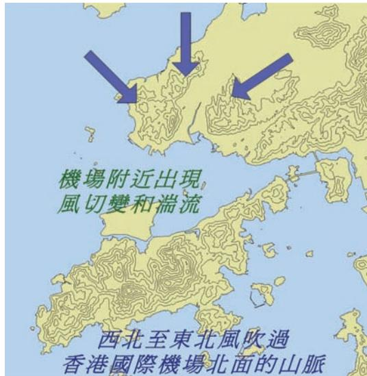
在颱大風的時候，例如在熱帶氣旋逼近時，高速氣流會在山峽形成。在這些高速氣流之間，有些較低速的氣流同時出現。當飛機沿著進場或離場走廊穿越這些高低速交替的氣流時，可能會在不同位置遇到逆風減少和增加的情況(見第 17 頁第二個例子)。
