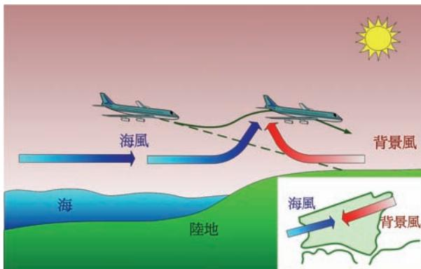
在下面的激光雷達掃描圖中，顯示典型與海風相關的風切變。海風一般在晴空的天氣下出現，激光雷達因而善於捕捉到海風鋒面。
