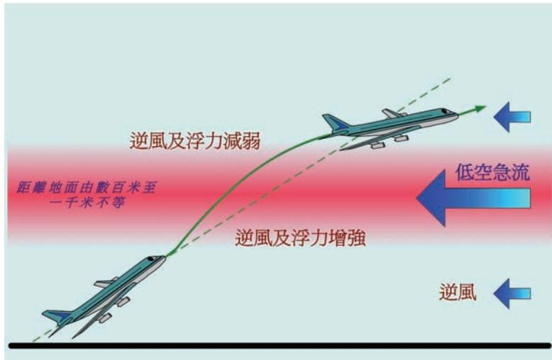
由於飛機著陸時一般是逆盛行風而飛行，當它穿越低空急流亦同樣會遇到一連串逆風轉變的情況。然而，由於飛機著陸時下降的斜度約為 3 度，較飛機起飛時的上升斜度為小，因此逆風轉變所帶來的影響也較起飛的飛機為小。
