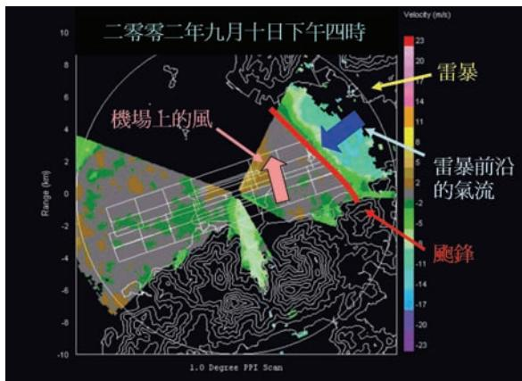
激光雷達二零零二年九月十日圖像。颱鋒由位於東北方的雷暴所產生，藍色箭頭代表它的移動方向。冷/暖色代表吹向/離開激光雷達的風(參見右面標度)。
