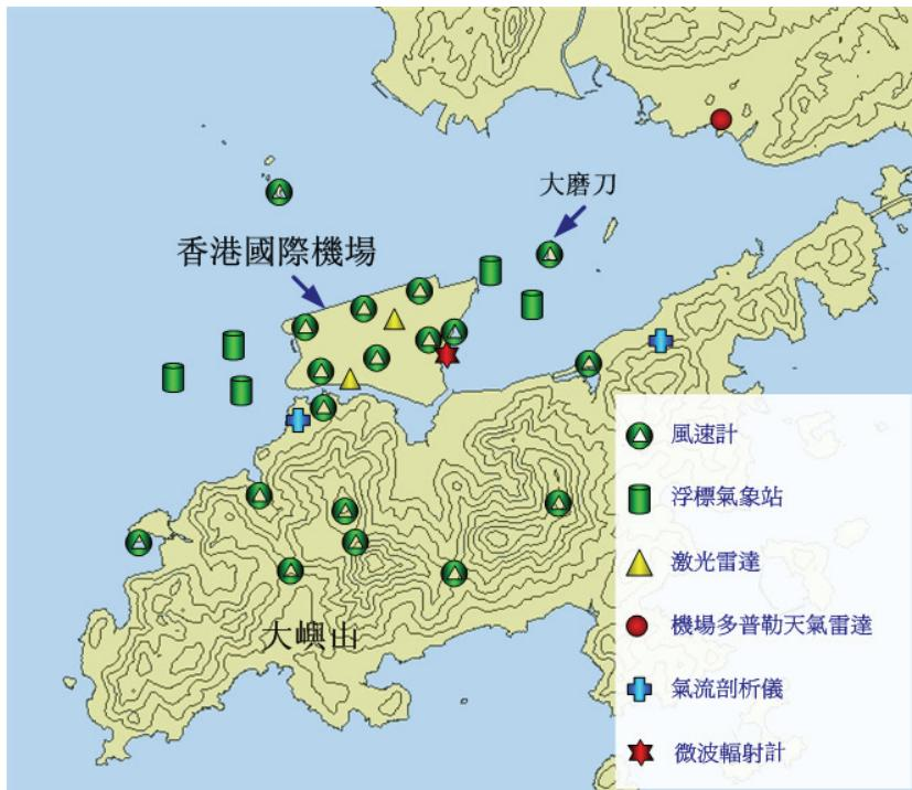
這些數據均實時地輸入風切變及湍流警報系統(風湍警報系統，WTWS)，當系統探測到風切變及湍流時，能每分鐘自動發出預警。
